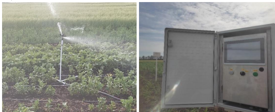
Рисунок 3. Полевые испытания автоматизированной системы комбинированного орошения
