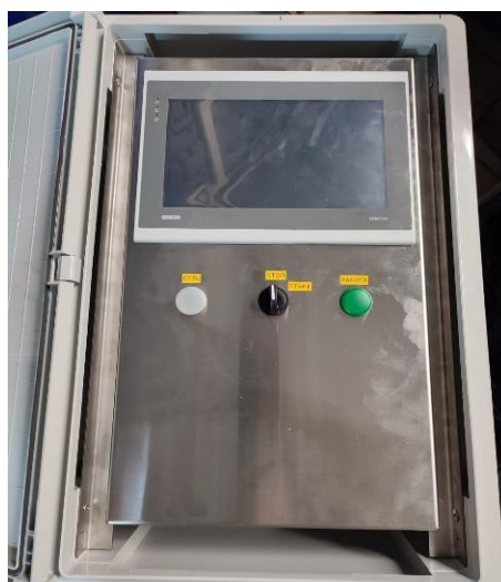
Рисунок 1. Блок управления автоматизированной системы комбинированного орошения
